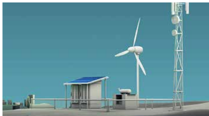
Site de télécommunication hors réseau avec solution hybride solaire, éolienne et diesel
